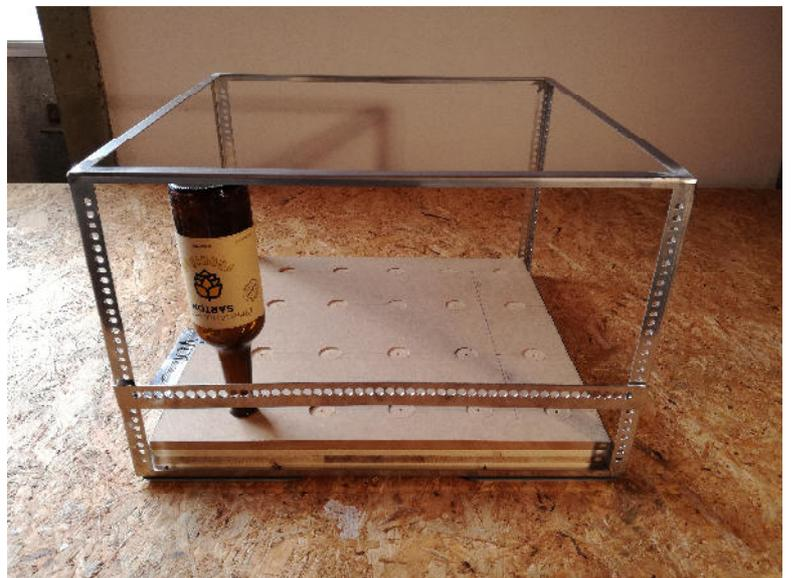
Montieren Sie nun die seitlichen und die hintere Trägerschiene.
