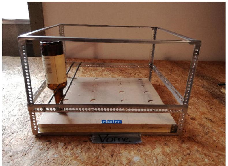
Nehmen Sie eine weitere Trägerstange, stecken Sie die Klammer an ein Ende und führen Sie diese durch die Öffnung der Trägerschiene. Beachten Sie dabei die richtige Position der Flasche. Befestigen Sie die Klammer am anderen Ende der Trägerstange.
