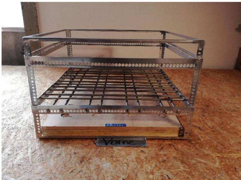
Bei der Montage der Trägerstangen ist darauf zu achten, dass die Flaschen gerade oder wenn nicht anders möglich, leicht nach links geneigt im Korb stehen.
