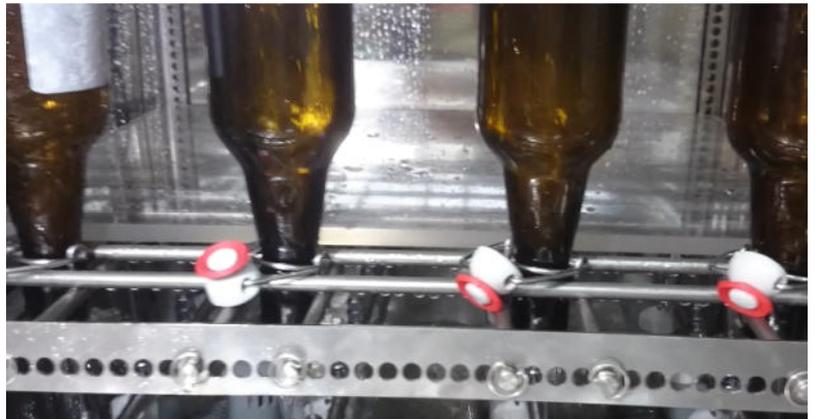
Sollte einer oder mehrere Nachspülarme nicht in die Flaschenöffnung spritzen, nehmen Sie einen Gabelschlüssel (Maulweite 20), lockern Sie die Mutter des Nachspülarmes und drehen diesen in die korrekte Position.
