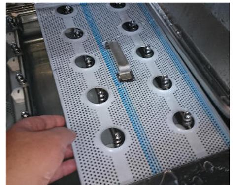
Entnehmen Sie den Ansaugfilter und ggf. reinigen Sie diesen wenn erforderlich. Wascharmee mit einer leichten Links-Drehung und leichtem Ziehen aus der Bajonethalterung entnehmen.
